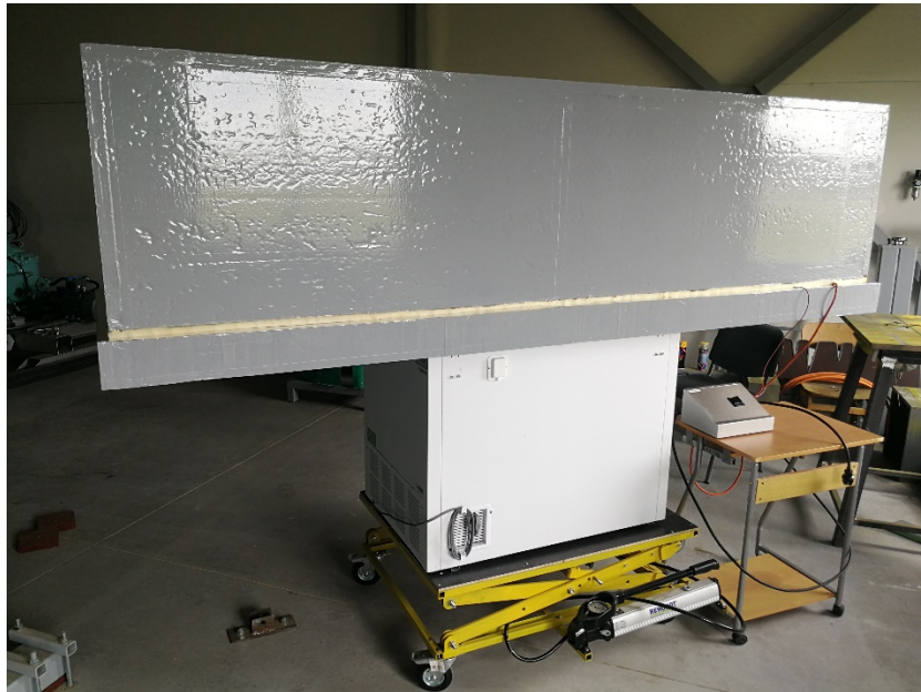
Att.2.2. Testēšanas stenda termālā kamera
